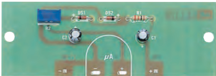
Fig.3 Foto del circuito siglato LX.1115. Lo strumentino andrà fissato su questo circuito come visibile in fig.4.
