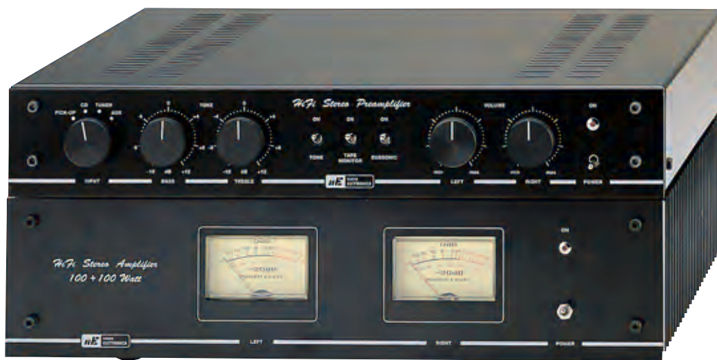
Fig.1 In questa foto vi mostriamo il completo impianto Hi-Fi composto dal preamplificatore a fet LX.1149-1150, presentato nel 1° volume Audio handbook, e dall'amplificatore con IGBT. Le alette di raffreddamento per gli IGBT compongono i due fianchi del mobile.
