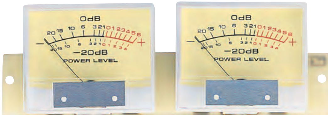
Fig.22 La mascherina frontale dell'amplificatore che vi forniamo insieme al mobile, è già forata per poter ricevere i due Vu-Meter visibili in questa foto. Chi non volesse inserire questi strumentini nell'amplificatore non deve richiedere il kit LX.1258, poi con un ritaglio di alluminio verniciato in nero o con un pezzo di plexiglas di colore rosso scuro dovrà chiudere le due finestre presenti sul pannello.
