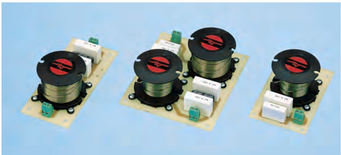
Fig.24 Tutti i filtri a 3 vie sono composti da tre stadi separati. Uno porta le note acute al Tweeter, un altro le note medie al Midrange e l'ultimo le note basse al Woofer.
