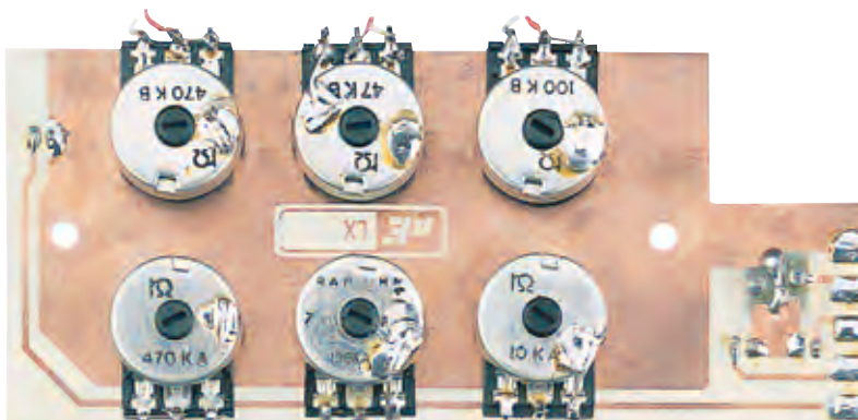
Fig.10 La scheda LX.1264/B dei potenziometri viene fissata sul pannello frontale con due distanziatori plastici autoadesivi.
