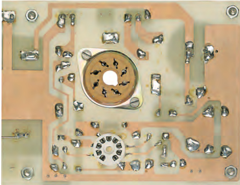
Fig.10 Gli zoccoli delle valvole vanno fissati dal lato opposto a quello dei componenti. I terminali degli zoccoli delle ECC.82 vanno saldati sullo stampato, mentre quelli delle EL.34 andranno collegati alle piste in rame con degli spezzi di filo (vedi fig.12).
