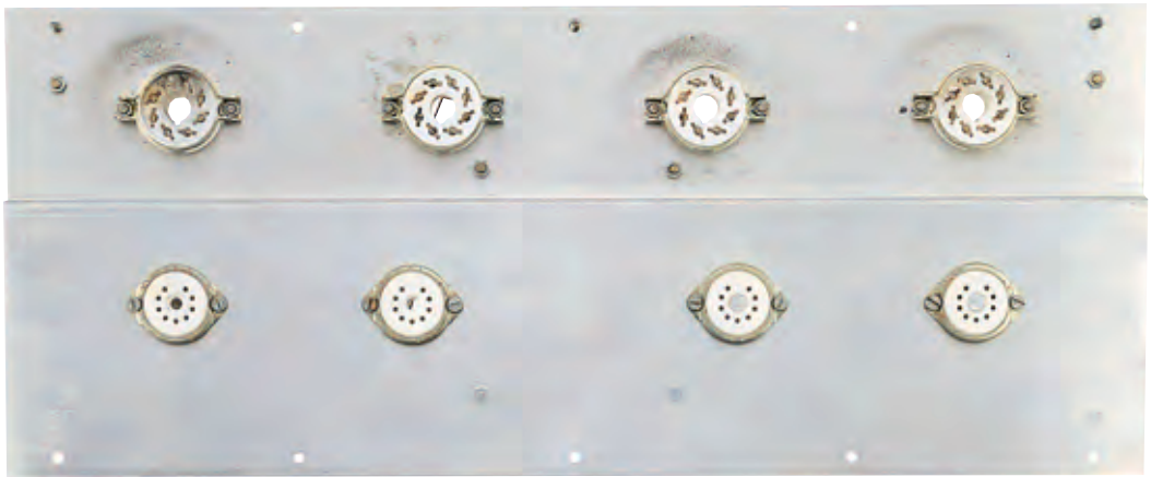
Fig.7 Gli zoccoli delle valvole vengono fissati sopra un telaio in alluminio ripiegato a Z, che funge da schermo per il circuito stampato sottostante.
